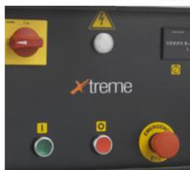
Commande électrique basse tension (24V AC) avec démarrage étoile/triangle
